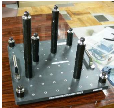
図 2 開発した日常点検用ゲージ
