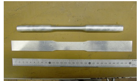
図 2 JIS Z 2201 の規定する試験片
