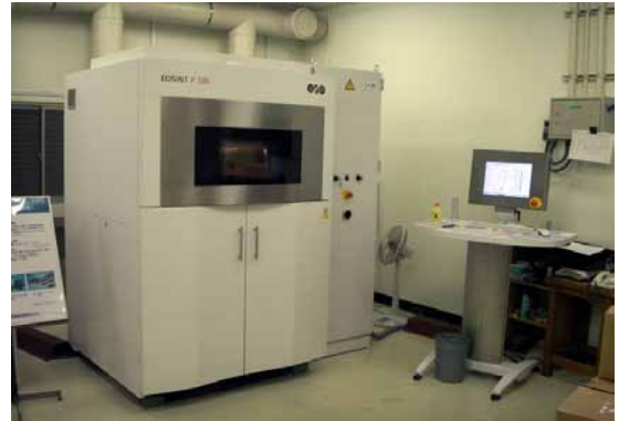
図1 ナイロン粉末焼結型 RP 装置
