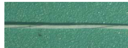
図2 撚糸品 7.5倍拡大 (SUS304 30 \mu m 撚数:300回/m)
