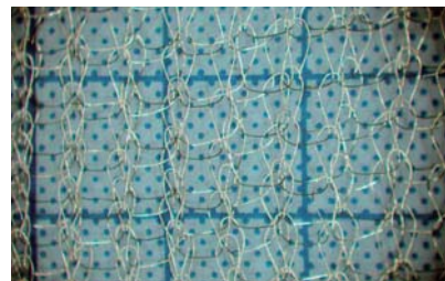
図3 金属繊維による編成物
