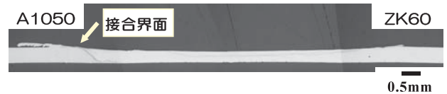
図6 厚さ0.4mmのA1050アルミニウムとZK60マグネシウム合金の摩擦攪拌接合部断面
