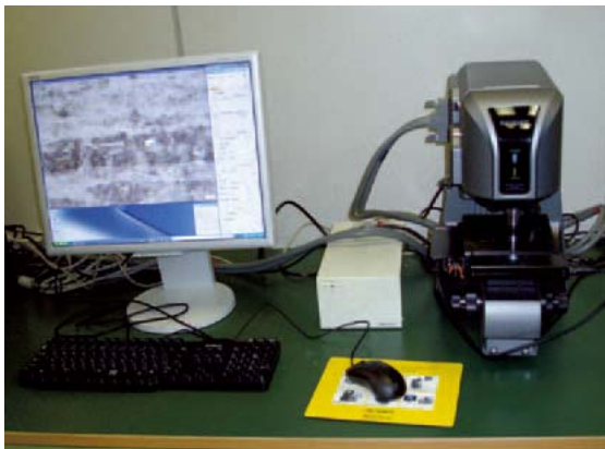
図1 カラー 3Dレーザ顕微鏡 (キーエンス製:VK-9710) 光源:バイオレット半導体レーザ(波長408nm) 観察倍率:200~18000倍 Z軸分解能:1nm
