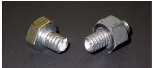
図1 過度の締付けによるボルトの破断
