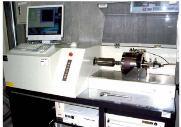
図2 ねじ締付け試験機概観
