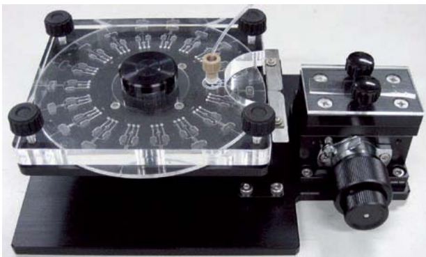
図 極微量分注装置の開発
