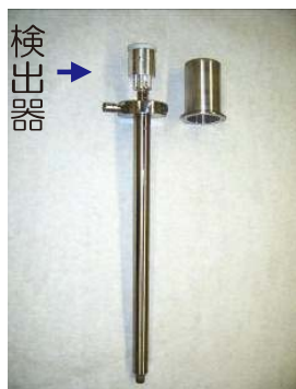
図3 左：遮蔽体内部 右：検出器（中にGe結晶がある）
