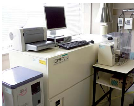
図4 装置外観 (Shimadzu ICPS-7510) シーケンシャルタイプのICP発光分析装置です
