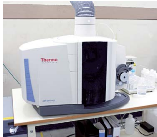
図1 装置外観（Thermo iCAP 6500 DUO） マルチタイプのICP発光分析装置です
