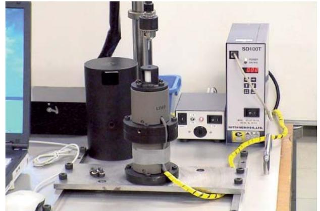
図1 締付け特性試験
