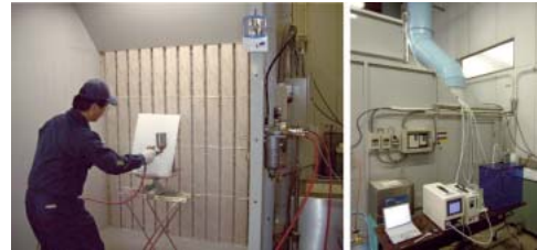
図6 塗装ブースシミュレータでのVOC発生状況の解析 実際に吹き付け塗装実験を行い、塗装ダクト等におけるVOCの発生状況を調査しています
