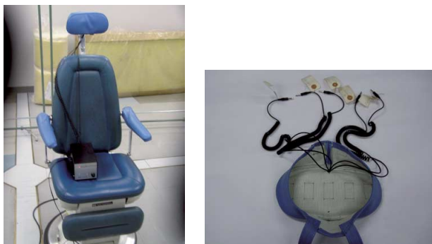
図1 骨電導技術を利用した耳鼻科診療椅子 ((有)京浜医科工業所との平成18年度共同研究) 骨電導スピーカを内蔵した枕部(右)と 装着した治療椅子(左)
