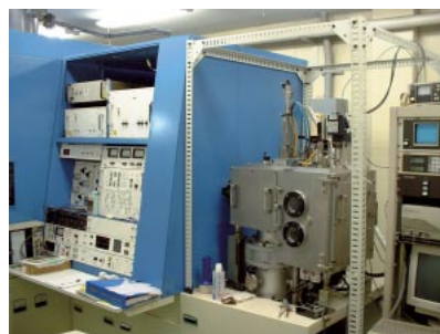
図2 高エネルギーで種々の元素を打ち込み、材料表面の改質を行うイオン注入装置
