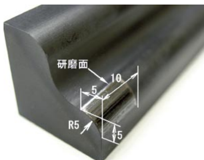
図1 CVDダイヤモンド被覆した金型の3次元曲面の研磨事例
