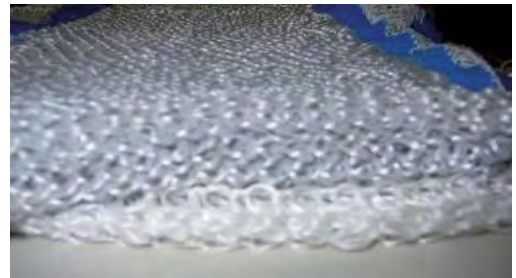
図3 編地厚さ効果イメージ図と編地厚さ付与編地表面・接結部ともに非伸縮系のみ（下）、表面部に伸縮系を使用した編地（上）です
