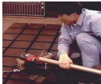
図3 セキュリティボルトの取り外し試験 強力な工具(パイプレンチ)にもしっかりガード
