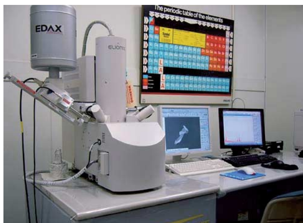
図1 電子線三次元粗さ解析装置の外観
