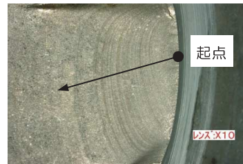
図2. 破断面の縞状模様
