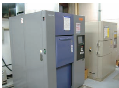
図3 冷熱衝撃試験装置 低温さらし温度：-70~0℃ 高温さらし温度：60~200℃
