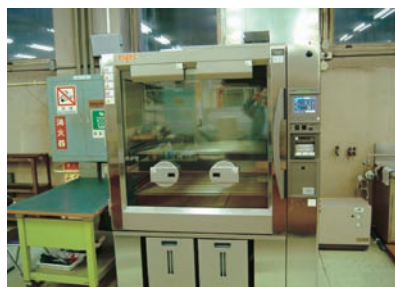
図2 恒温恒湿槽 温度範囲：-40~90℃ 湿度範囲：20~98%rh テストエリア寸法：W960×H960×D800
