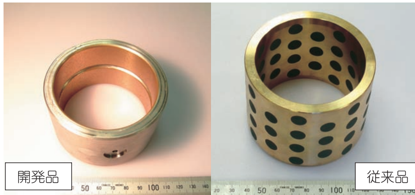
図1 焼結ブッシュ（開発品）および汎用鋳造ブッシュ 従来、右側の図のアルミニウム青銅鋳造材に黒鉛を埋め込んだブッシュが使用されていたところに、左側の図のように鋼板に黒鉛を均一・微細分散させた焼結材料を貼り付けた焼結ブッシュを開発しました。
