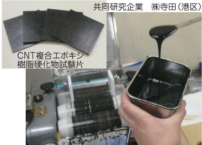
CNT複合材料の創製には高いせん断力の印加による精密分散・混合(上写真)が有効な手法であることが実証されました。巨大なCNT複合材料マーケットに多くの企業が参入しています。導電性接着剤・エポキシ樹脂製品を製造販売している(株)寺田は、専門の開発チームを立ち上げ、機能性CNT複合樹脂の開発を行っています。
