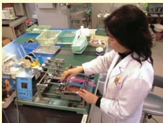
摩擦堅牢度試験 染色物が使用中に摩擦された時の汚染の程度を調べます。
