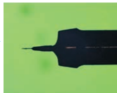
図2 完成した数ミクロンの工具
