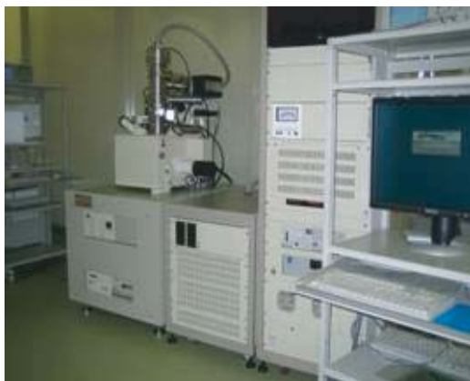
図6 FIB(収束イオンビーム)加工装置 金属、セラミックのナノ加工ができるナノテク対応機器です。
