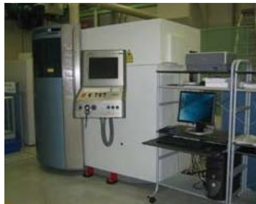
図7 レーザ型彫り装置 6軸の型彫り加工が可能なレーザー型彫り装置です。
