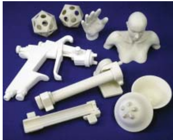
図5 3次元造形機による試作例
