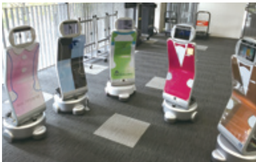
着せ替えロボット「コンシェルジュロボット」 デザインカスタマイズ性と低コストを両立させたロボット
