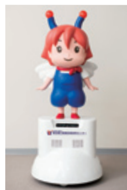
マスコットキャラクターロボット「チリンロボット」 都産技研のマスコットキャラクター「チリン」をデザインしたロボット。人追従機能や音声認識による会話機能を備えている
