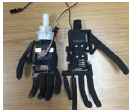
3Dプリンターで製作されたモーター 2個仕様の筋電義手
