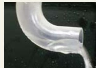
図4 光造形装置により製作した模型を用いた流れの確認例
