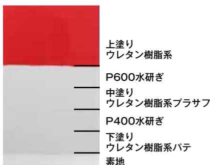
図1 確立した塗装工程例
