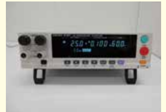
保護導通試験器 メーカー：日置電機 型番：3157
