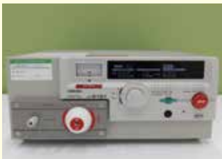
耐電圧試験器 メーカー：菊水電子工業 型番：TOS5101
