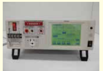
漏れ電流試験器 メーカー：日置電機 型番：ST5540
