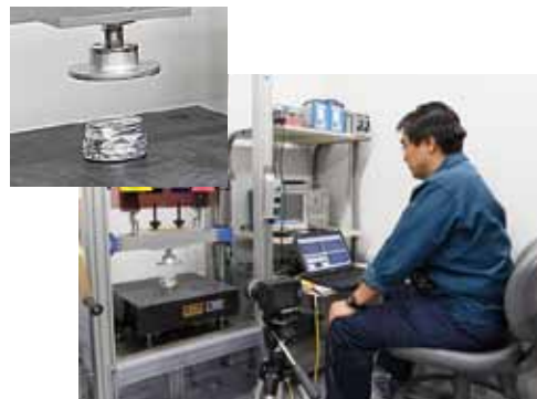
アルミ缶に衝撃荷重を加え測定する様子
