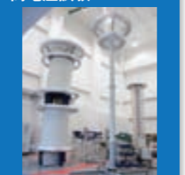
交流高電圧発生装置
