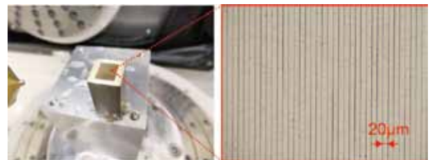
図3 黄銅への引き切り加工例 (V溝90°)
