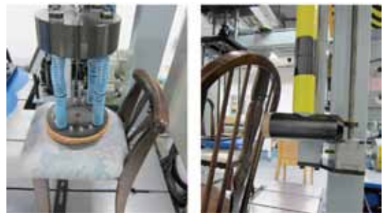
図2 衝撃試験用ジグ
