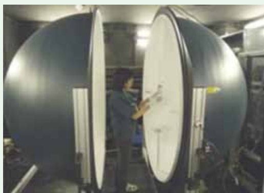
写真1 光束測定の作業風景 LED用球形光束測定装置
