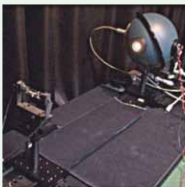
写真2 全光束基準LED校正装置
