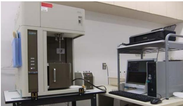
図1 比表面積／細孔分布測定装置
