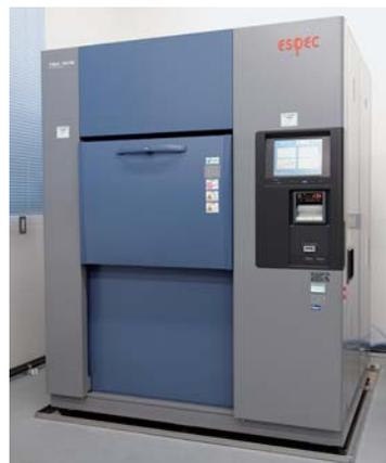
図1 冷熱衝撃試験装置
