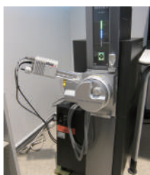
走査型電子顕微鏡+エネルギー分散型蛍光X線分析装置 ▶(株)キーエンス アメテック(株) VE-9800+Appollo10
