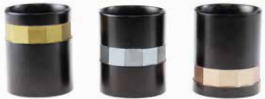
積層金型のプレートの順番を入れ替えて 圧縮成形したさまざまな意匠のぐい呑み
