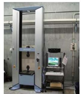
図3 万能試験機 (左：100kN, 右：20kN)
