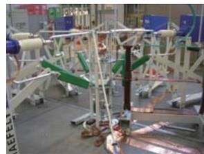
図2 交流高電圧発生装置(左上) 雷インパルス電圧発生装置(上右) 雷インパルス電流発生装置(下/イメージ)
