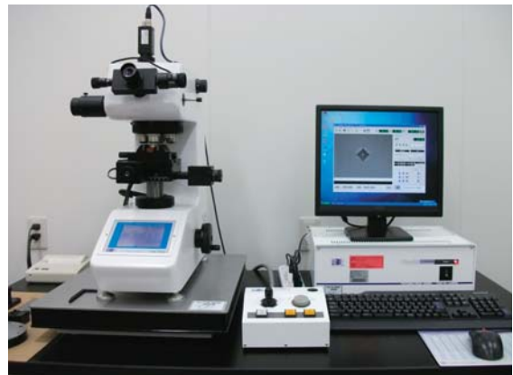
図1 マイクロビッカース硬さ試験機 試験機本体(左)と制御装置(右)
