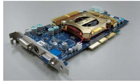
図2 GPUを搭載するビデオカードの例 通常は映像出力に用いられる
