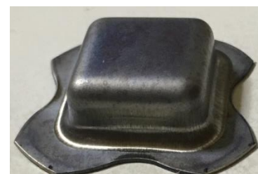
図3 角筒プレス成形例2 (Ti-6Al-4V合金、初期板厚0.5 mm)
