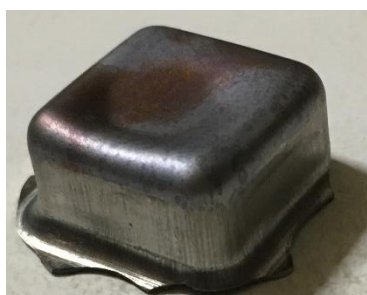
図2 角筒プレス成形例1 (Ti-6Al-4V合金、初期板厚0.5 mm)
