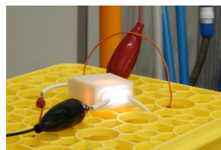
図4 フラッシュオーバー試験例（放電時の様子）
