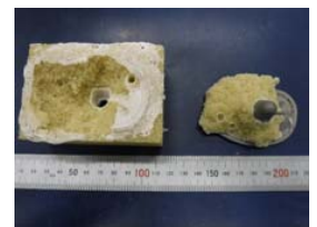
図4 優れたインプラント 固定性能（固定強度 > 模擬骨の強度）
