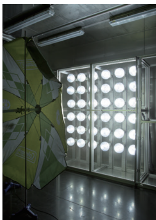
日射環境試験装置 (主室)
