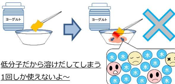
○pH試験紙やpH電極の場合、水中へ内部の薬液が溶け出てしまう。開発した色調変化型高分子フィルムは、色調変化を示す部位が化学結合しているため水中に溶出せず、水溶液を汚染しない。
