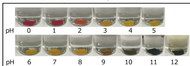
【中性領域タイプ】合成の難しい中性域の高分子フィルムで水中に溶解するCO<sub>2</sub>をモニタリングできる可能性がある。
