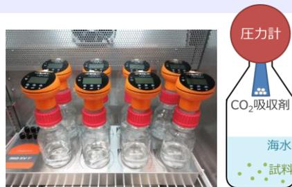
図1 BOD測定の様子(左)と装置模式図(右)
