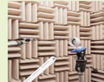
無響室での音響特性測定 周波数特性、指向特性な どの試験を実施し、音響 性能を見える化。
