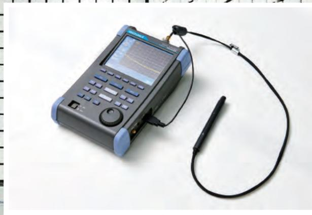
電子計測機器を扱うマイクロニクス株式会社と都産技研は、2019年度の共同研究により、9 kHzの低周波伝導性妨害ノイズの測定に対応した磁界プローブ「MMP500」の開発を行いました。「MMP500」の製品化は、共同研究の開始から1年あまりという異例の早さで実現しました。共同研究や製品化はどのように進められたのか、マイクロニクス株式会社 生産事業部の樋口 実 氏と、多摩テクノプラザ電子技術グループの高橋 文緒 主任研究員に話を聞きました。
