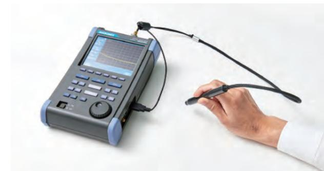
図2 開発した磁界プローブ
