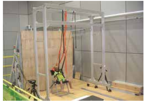
チャイルドドグミーを有する衝突安全性試験機
