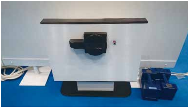
試作した充電システム給電側
