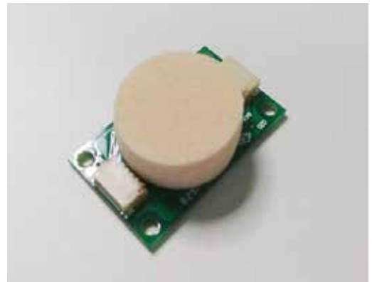
使用した接触センサ (タッチエンス株式会社 POT-D-SN18X10CN)
