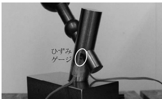
図4. ひずみゲージの貼り付け状況
